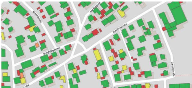
Die Eignung der Dachfläche für Photovoltaik und Solarthermie wird jeweils in farblich unterschiedlichen Eignungsstufen dargestellt. Außerdem können Sie sich die nutzbare solare Einstrahlung auf die Dachfläche anzeigen lassen.
